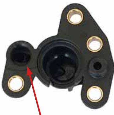
Absence d'une valve de contrôle
